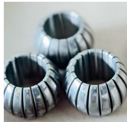
Die Vielfalt der bearbeiteten Aufträge ist fast grenzenlos. Diese Stahlkugeln wurden von Qualicut für spätere tribologische Versuche aufgeschnitten.
