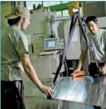
Chromstahl und Aluminium machen den Löwenanteil der bearbeiteten Materialien aus. Daneben findet vom Schaumstoff über den Verbundwerkstoff bis zum Hartmetall so ziemlich alles seinen Weg auf die Wasserstrahlschneidsysteme. (Bilder: Marc Kollmuss)
