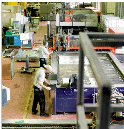
Mit dem Einzug des ByJet Pro (hinten) haben sich die Kapazitäten bei Qualicut von vier auf acht Schneidköpfe verdoppelt. Im Vordergrund zwei Bystronic ByJet 4022 Anlagen.
