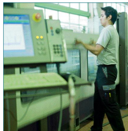
Die Kapselung der Maschine, sorgt am ByJet Pro für eine saubere und geräuscharme Arbeitsumgebung.
